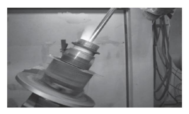
Рисунок 24 - Внутреннее восстановление[37]. цилиндра двигателя
