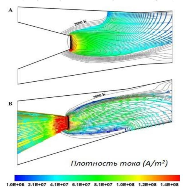
Рисунок 9 - Распределение плотности тока (цветовая шкала векторов) вблизи острия катода плазмотрона с монокатодом постоянного тока и изотермы (черным цветом); а - с наложенным профилем плотности тока на поверхности катода; б) - с дуго-катодной связью (расчеты Алая и др. [23]. Ток дуги 600 А - плазменная газовая смесь аргона (45 слм) и водорода (15 слм)
