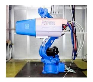
Рисунок 3 - Автоматизированные комплексы для нанесения ХГН-покрытий [7]
