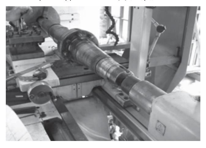
Рисунок 25- Вал колеса поезда[37]
