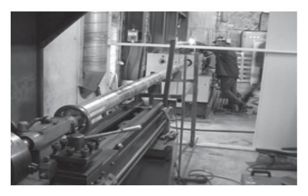
Рисунок 26 - Корабельный трансмиссионный вал[37].
