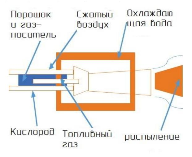
Рисунок 4 - Газовый термораспылительный пистолет высокоскоростного кислородно-топливное распыление
