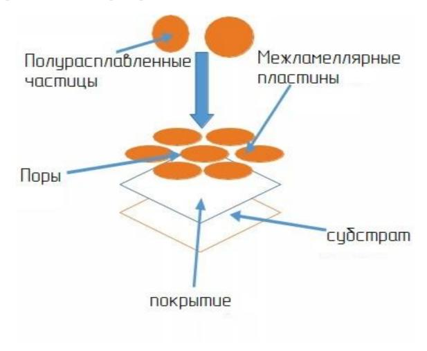
Рисунок 5 - Схема, показывающая типичные особенности покрытий высокоскоростного кислородно-топливное распыление
