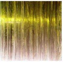
б)Износ схватыванием второго рода
