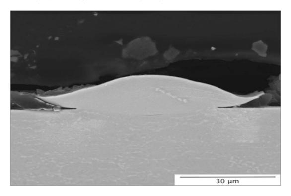
Рисунок 2 - Одиночные покрытие частиц TiAlV64 холодным напылением на титане
