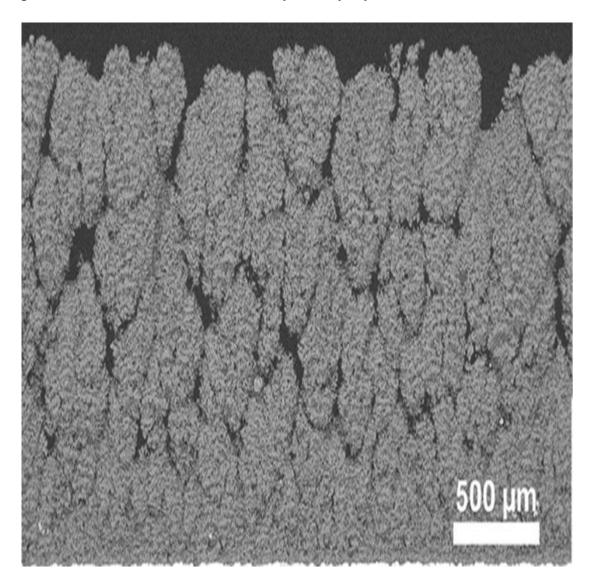
Рисунок 11 - Покрытие, нанесенное суспензионным плазменным напылением (Mg-Al-шпинель)[30]
