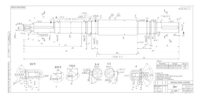
Рисунок 15- Чертеж вала
