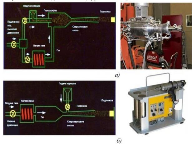
Рисунок 1 - Установки ХГН-покрытий: а) с высоким давлением; б) с низким давлением [5]
