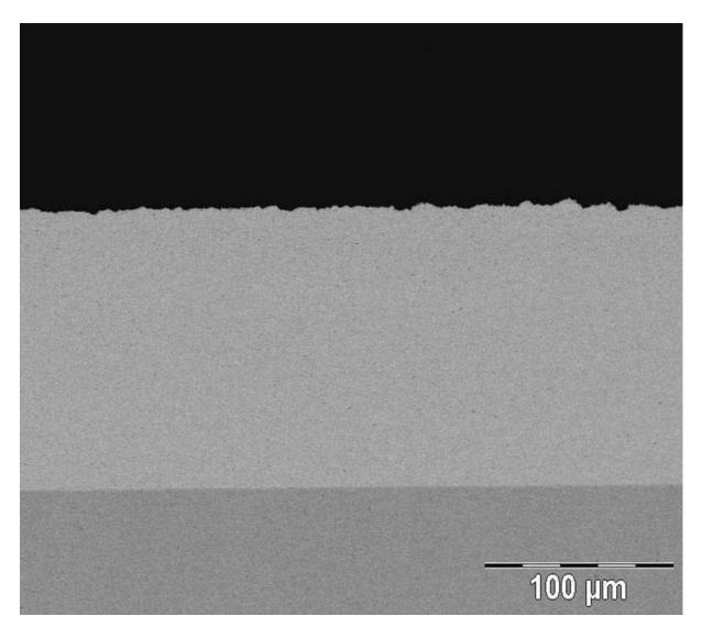
Рисунок 10 - Покрытие, нанесенное суспензионным плазменным напылением (диоксид циркония, стабилизированный иттрием), полученное Joulia et al[30].
