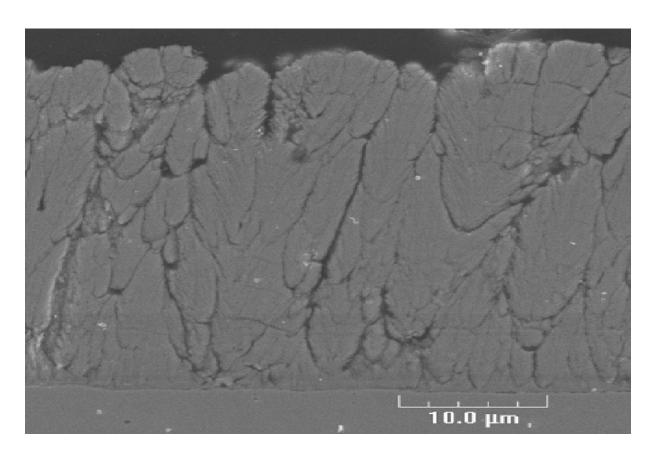
Рисунок 12 - Покрытие, напыленное плазмой (стабилизированный иттрием диоксид циркония) низкого давления[30]
