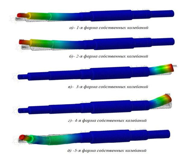
Рисунок 22- Карта результата на расчет собственных частот Таким образом, были выполнены расчеты методом конечных элементов для детали вал[36].
