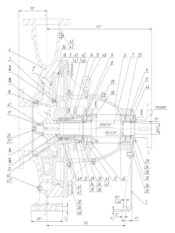
Рисунок 14- Чертеж центробежного консольного насоса СНР 150-500. Часто износ вала возникает в контакте с деталью рабочее колесо поз.3, втулка упорная поз.12, также подшипники 57,58 в случаях подшипники просто заменяют
